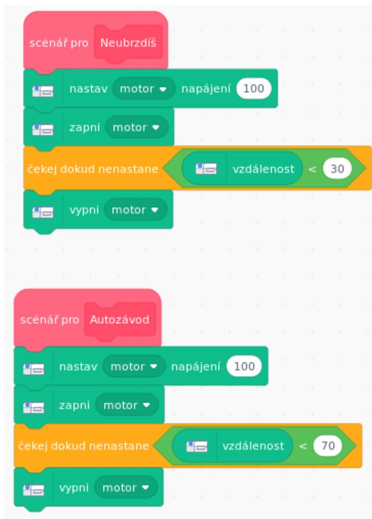
Obrázek 3.18: Rozjede motor a zastaví po zaregistrování překážky. Jednoduchá varianta bez zpětnovazebního řízení.
