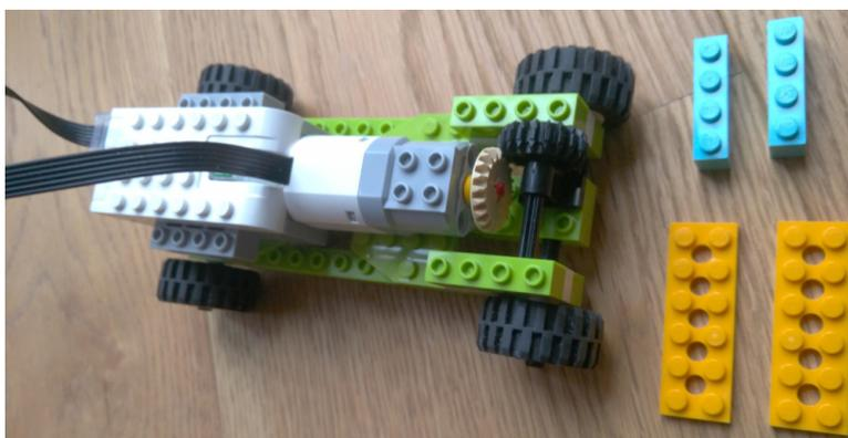
Obrázek 3.12: Sestrojte převodovku, která v této variantě má tendence se rozpadat, připravte se na její zpevnění.
