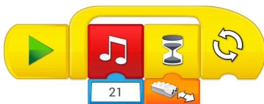
Obrázek 3.20: Takto je možné sensor donutit, aby pípal, jakmile vidí změnu vzdálenosti.
