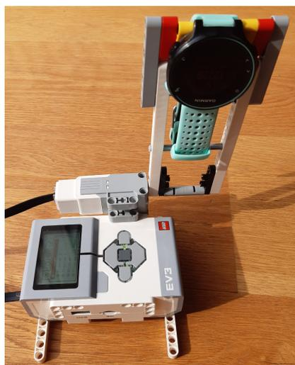
Obrázek 4.2: Blok s jedním motorem na pohyb hodinek.
