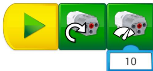
Obrázek 3.16: Rozjede motor na plné otáčky.
