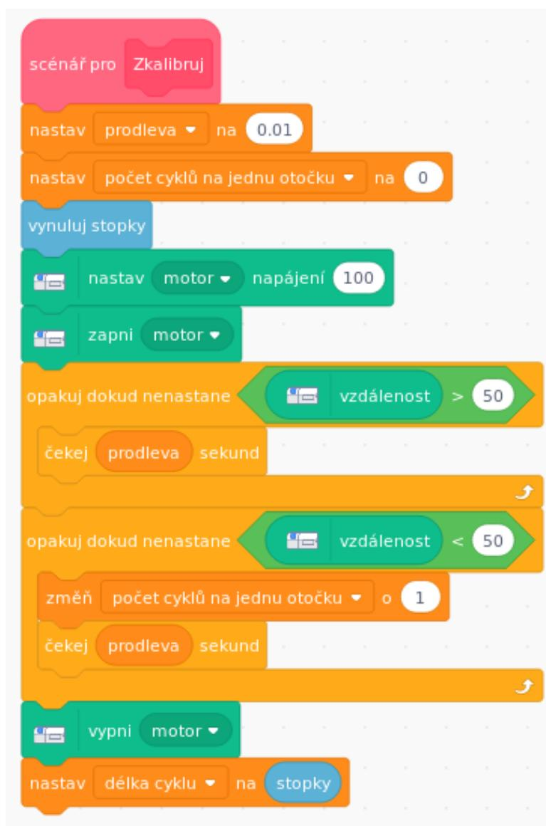
Obrázek 3.34: Kalibrace proměnné délka cyklu na jednu otočku
